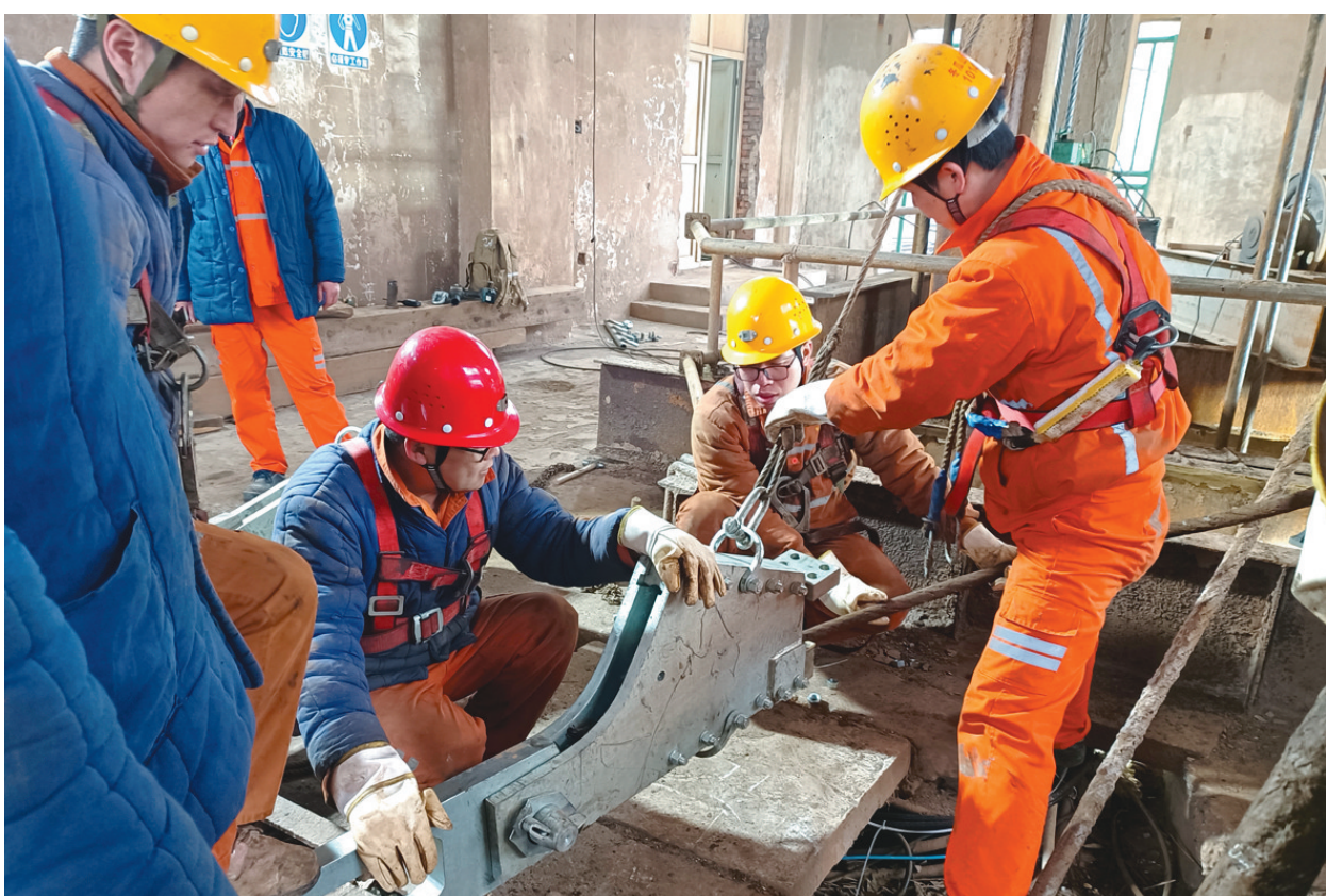
日前,冬瓜山铜矿提升二区对冬辅助井钢丝绳连接装置进行更换。该工区提前做好准备组织维修工将新的绳头连接装置运送到指定地点,更换时维修工先用快速绳卡卡住钢丝绳做好保护,再用电动绞车将磨损超标的首绳绳头连接装置提上来拆除并装上新的,经过9个多小时作业,4个绳头连接装置更换圆满完成,确保卷扬机顺利提升。 王松平 摄
