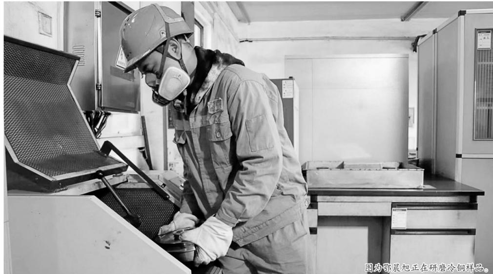
图为鄂展旭正在研磨冷铜样品。
