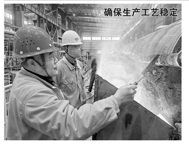
近日,铜冠(庐江)矿业公司技术人员正在指导安装磁选机溜槽支撑。该公司为提高选铁回收率及铁精砂品位,精心 组织维修人员对磁选机进行调试,通过调节磁选机磁偏角、更换磁选机精矿溜槽等措施,提高了作业区工艺流程稳定性,
