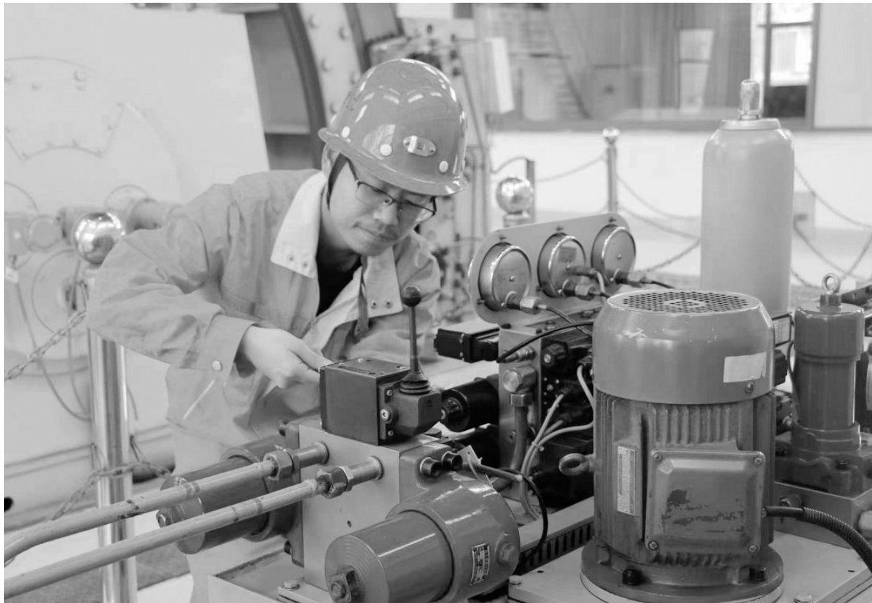
图为洪亿昆在调试设备液压系统。
