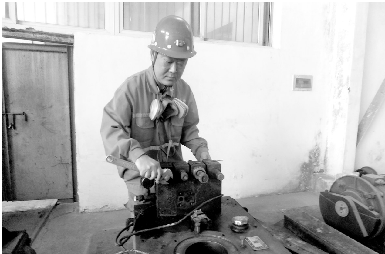
图为章俊在车间对井下放矿漏斗操作液压缸进行维修。
