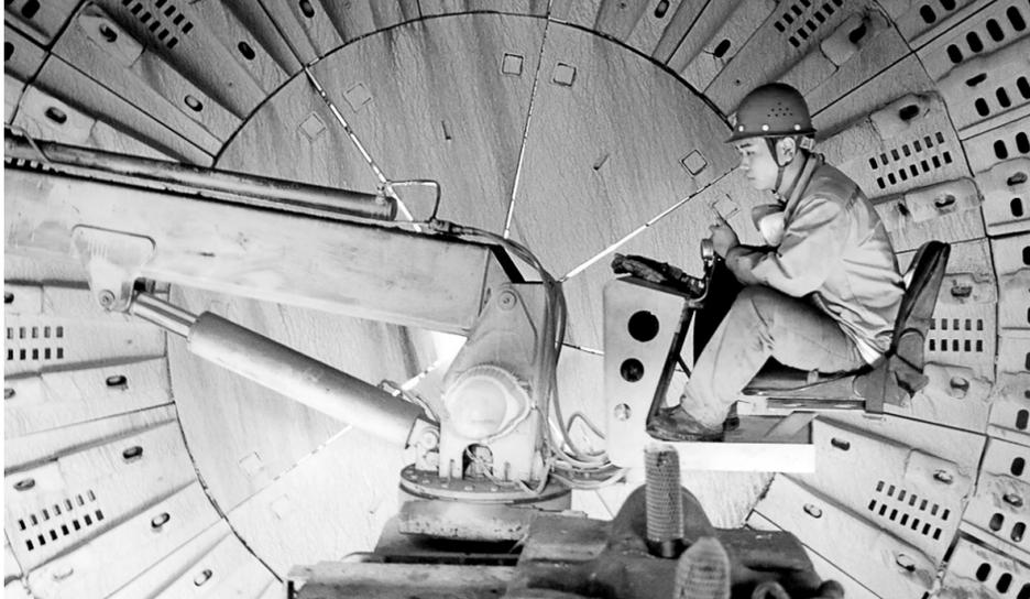
铜冠(庐江)矿业公司注重技术工人的多方面培育,对新员工进行技术和思想“双培养”,让其成为矿山发展中坚力量。图为近日该公司预备制技工在操作半自磨机衬板机械手新技术。 黄从娥 摄
