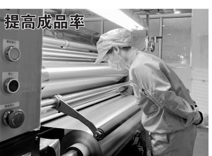
为提高5G通讯用HVLP铜箔成品率,今年以来,铜冠铜箔公司从工艺 改进和设备改造入手,进行了反复试验,目前,HVLP铜箔成品率有了较大 提升。图为近日该公司分切员工正在通过观察产品外观来检验分切机的 改造效果。 何亮王丽摄
