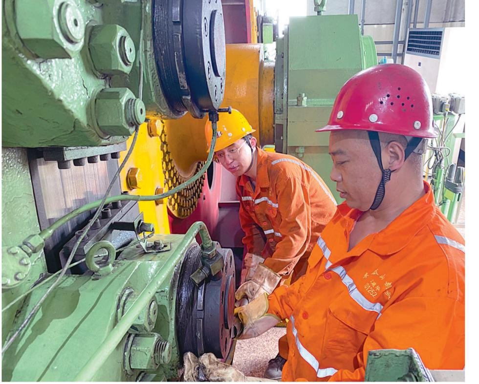
日前,冬瓜山铜矿提升一区维修人员对主井卷扬机盘形制动器制车间隙进行调整。主井提升是该矿生产的“咽喉”要道,保证卷扬机的安全运行尤为重要。该工区安排维修人员每周对卷扬机盘形制动器各个零部件逐一进行检查调整,使每组制车间隙达到技术要求,以确保设备的高效运行。
