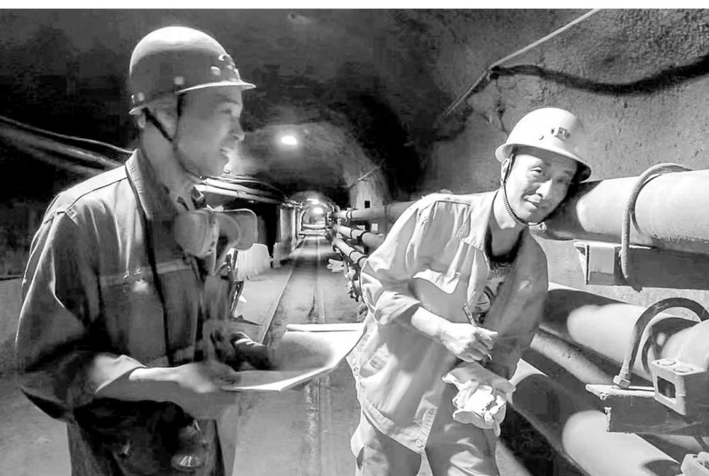
图为冬瓜山铜矿充填区班组员工正在进行井下充填管道防腐摸底确认。
