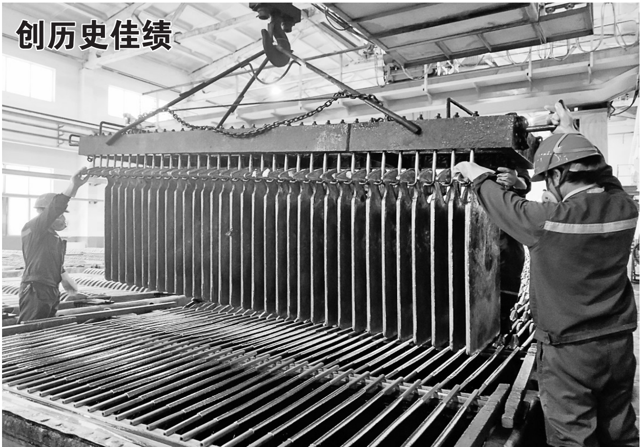
近日,铜冠有色池州公司铅电解操作员工在装出槽作业。进入10月份以来,铅分厂加压奋进冲刺四季度,以超出预算的标准排定增产计划,用高产稳产努力为公司历史最好年添光增色。
