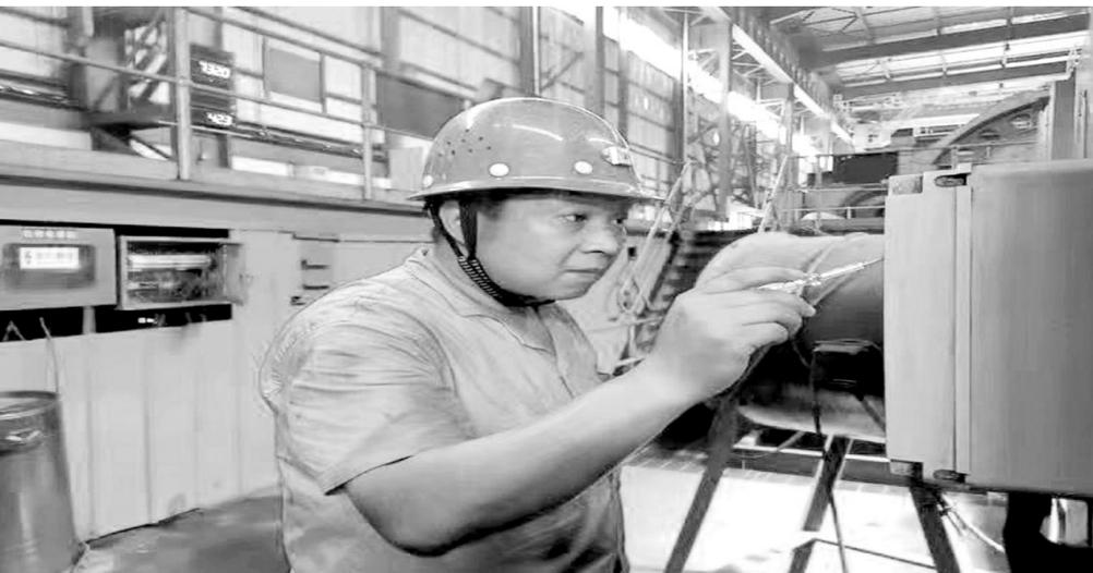
图为齐平波检查半自磨机干油喷射装置。
