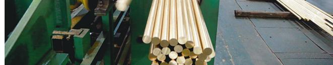
近日,铜冠铜业公司正在生产大棒。铜冠铜业公司今年以来通过加强质量和工艺改革,对生产中发现的质量问题,及时召开现场质量分析会,分析产生问题的原因,提出改进措施和对策,最终固化为生产工艺。产品质量得到明显改善,解决了小棒发黑、大棒和异型材直度、表面等质量难题。王红平 汪勇 摄
