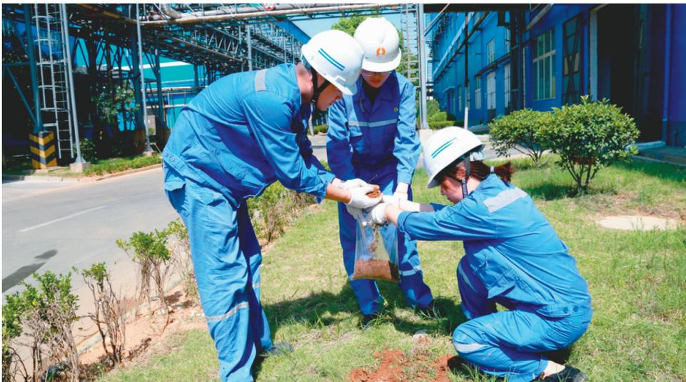
日前,金隆铜业公司化验技术人员正在厂区制备土壤样本。该公司坚持绿色生产,以打造“与城市共融的多金属回收绿色工厂”为企业愿景,常态化在厂区各主要生产区域采集土壤样本,通过对土壤成分的精密化验,检测分析不同区域土壤样本的各类指标,探索分析冶炼生产对厂区土壤环境的影响,以便更科学精准地规划指导生产,适应公司环境友好可持续发展的需要。
