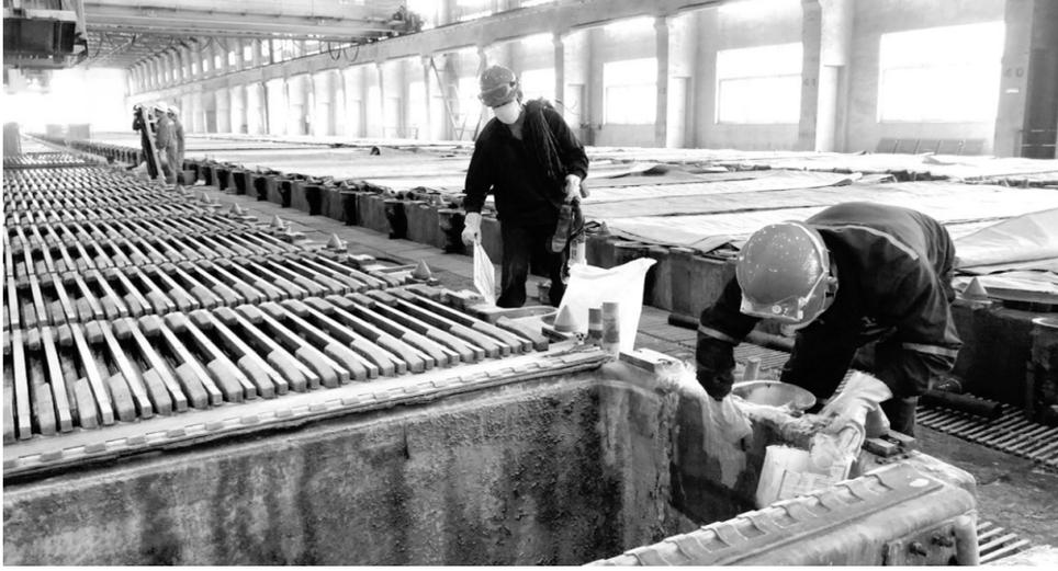
近日,金隆铜业公司电解深加生产期间对电解槽的日常检查维护,及早发现及时修补,保证了电解系统生产稳定,有效降低了环保风险。该深加常规电解区域的电解槽于建厂初期投入使用,由于电解液的长期腐蚀,槽体鼓包、玻璃钢老化状况较多。该深加在做好日常检查维护的同时,制订计划有序安排电解槽修补工作,及时进行电解槽槽体、保温层的修复,以及大小堵件及溢流盒的更换等。
