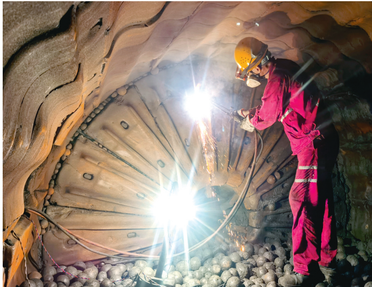
日前,天马山矿业公司利用限电停球期间,组织员工对球磨机进行检修维护。该公司周密做好维修人员和设备防暑降温工作,合理安排作业时段,圆满完成球磨机端盖衬板调整更换的检修任务。
