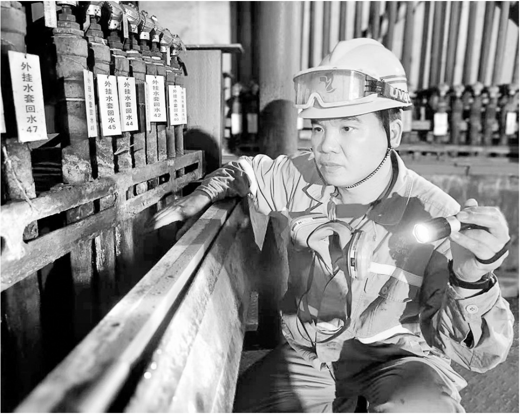
图为王乾在查看奥炉水套回水温度与流量是否正常。
