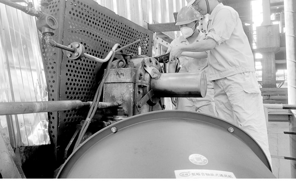
7月15日,铜冠冶化分公司球团车间设备专巡员在检测抽风机轴瓦温度和振动值。自7月高温以来,该分公司球团车间成立设备专巡小组,结合球团工艺设备特性,对三大主机、工艺风机等重点高温设备进行细致周到的每日“体检”,并建立记录台账,全面保障高温天气下设备安全稳定运行,为“战高温、夺高产”创造有利条件。
