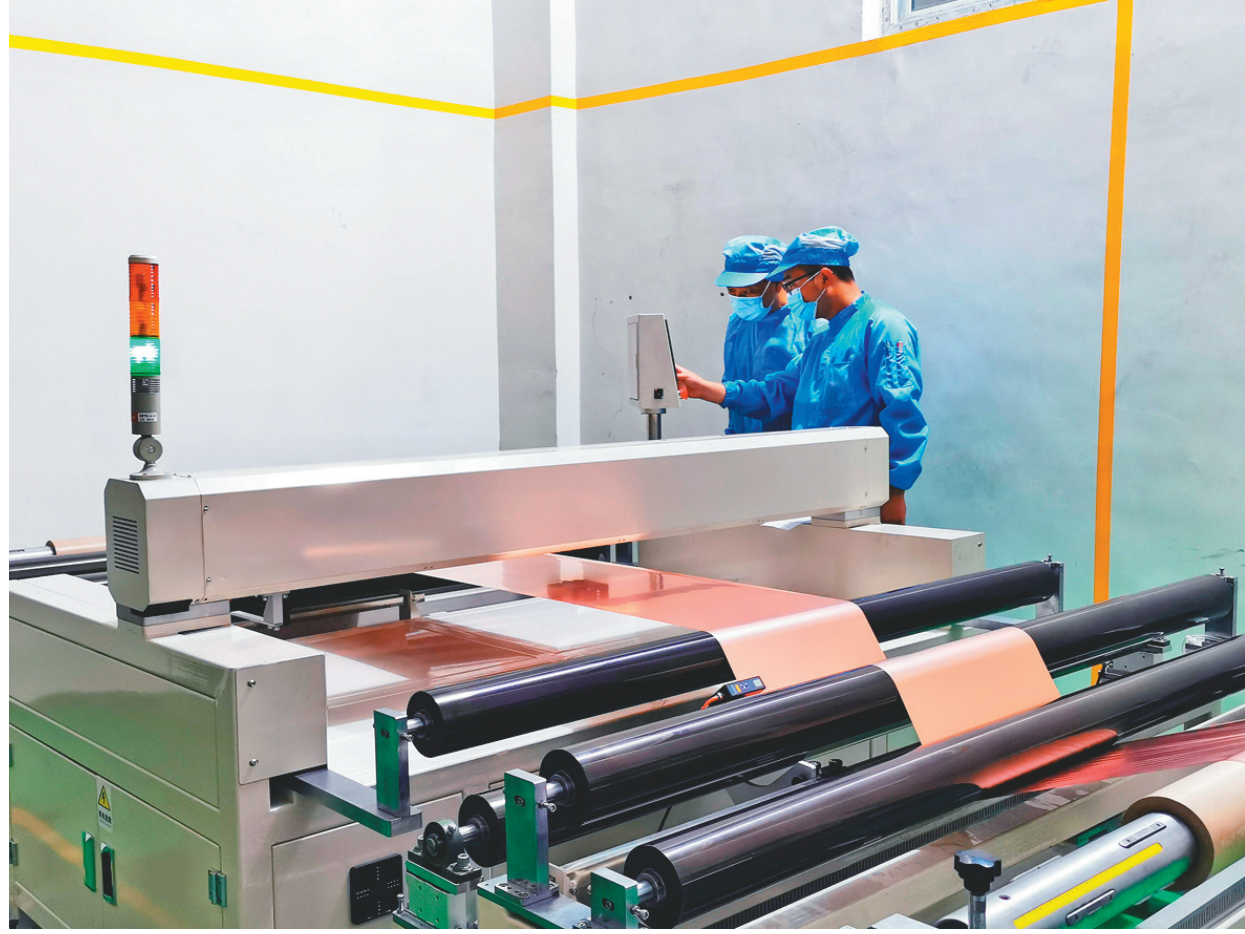
为不断提升铜箔产品质量,铜冠铜箔公司相继引进面密度仪、板型仪等智能化检测设备,有效杜绝了存在瑕疵的产品流出。图为日前该公司铜箔五六工场分切工正在使用板型仪检测箔面波浪差值。 何亮摄
