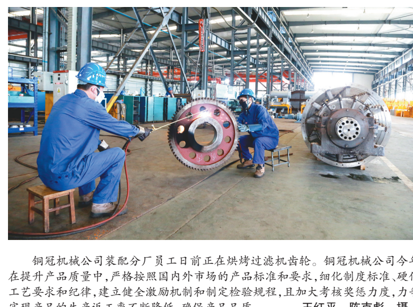
铜冠机械公司装配分厂员工日前正在烘烤过滤机齿轮。铜冠机械公司今年在提升产品质量中,严格按照国内外市场的产品标准和要求,细化制度标准、硬化工艺要求和纪律,建立健全激励机制和制定检验规程,且加大考核奖励力度,力争实现产品的生产返工率不断降低,确保产品品质。 王红平 陈克彪 摄
