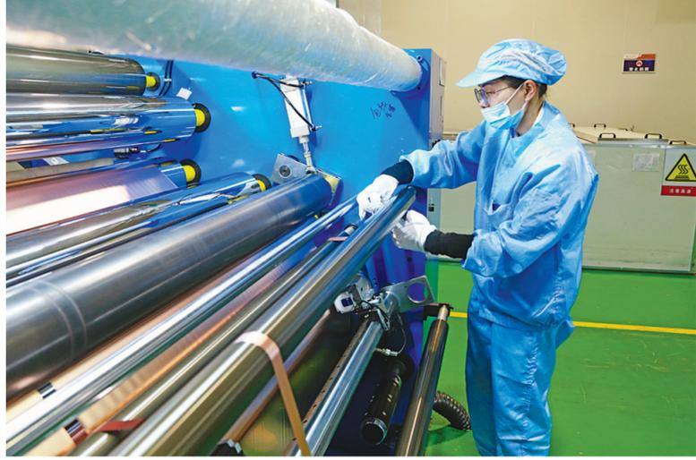
铜冠铜箔公司铜陵工场员工日前正在分切作业。该公司今年在推进生产模式升级上,紧密结合下游客户需求,将着力解决制约指标提升的关键技术,聚焦新能源汽车、储能及5G市场需求,加大铜箔新产品、新技术的研发力度,组织开展RTF2铜箔、HV-LP2铜箔、HVLP3铜箔、第二代高抗拉强度极薄电子铜箔及载体铜箔的技术研发,争做行业发展的领跑者。王红平 刘汤青 摄
