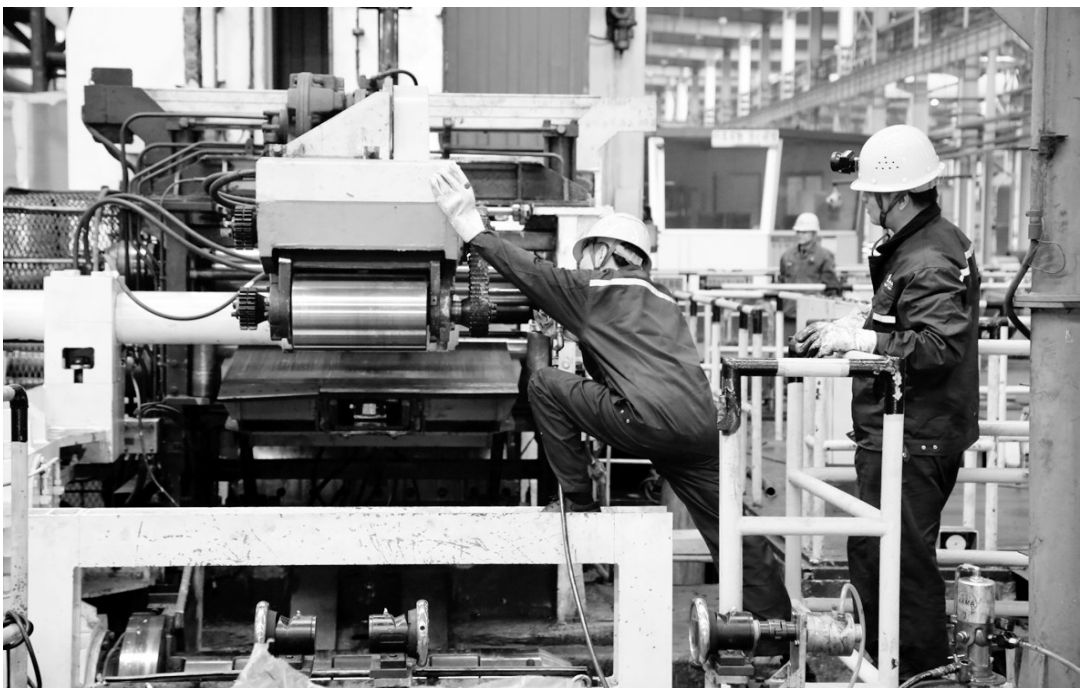
金成铜业分公司员工目前正在对粗轧机保养。该公司在设备管理中,积极推行设备勤听、勤看、勤摸、勤闻“四勤”管理,以定期周检、专业巡检和小组巡检相结合的形式,实施设备预修制度,坚持设备每周定期停机维修维护制度,提高点检和维修质量,保障了设备开动率。
