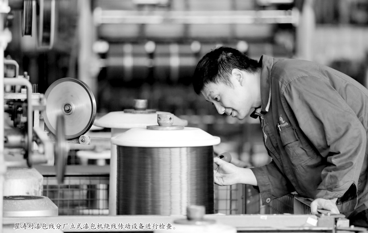
瞿涛对漆包线分厂立式漆包机绕线传动设备进行检查。
