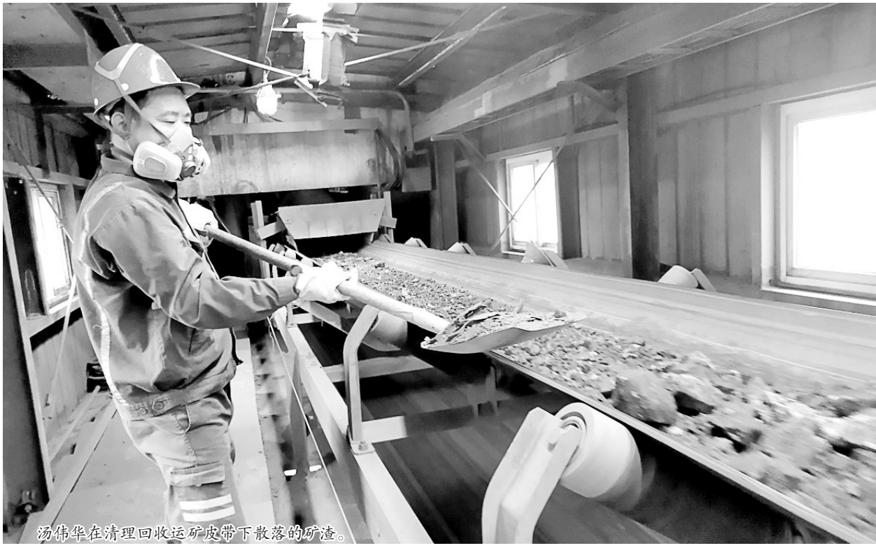
汤伟华在清理回收运矿皮带下散落的矿渣。
