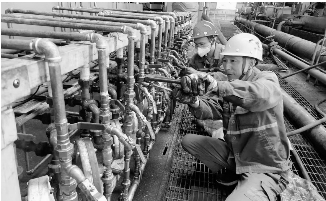
4月28日,铜山铜矿分公司选矿车间技术人员在对浮选关键系统加药机进行检查维护、标定校准。该分公司针对选矿原有浮选加药机存在加药管道易软化等情况,将原PVC管道更换为不锈钢管道,有效解决了加药机故障率高等问题,提高矿山选别过程中,关键技术参数的科学性、准确性,为矿山选别指标提高创造有利条件。 张 震 唐玉弟 摄
