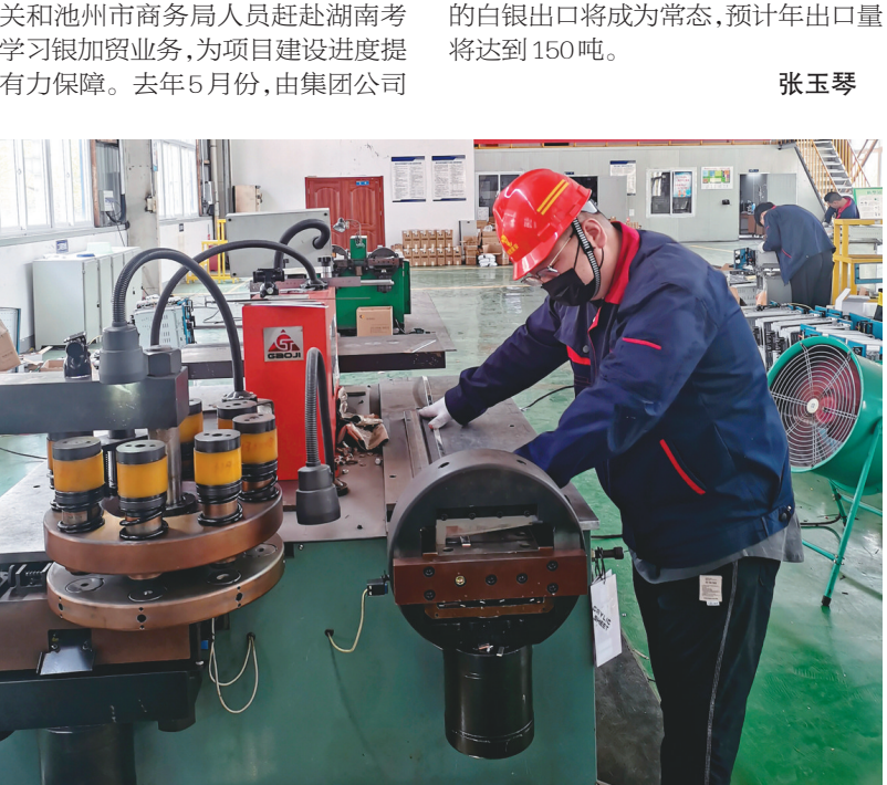
日前,铜冠建安电控设备厂职工正在制作铜排。该厂自4月6号复工以来,严格执行疫情防控要求,确保复工后防疫和生产安全。同时,该厂积极组织职工大干,掀起施工生产热潮,抢抓疫情期间耽误的工期。 汪锡铜 阮景胜 摄
