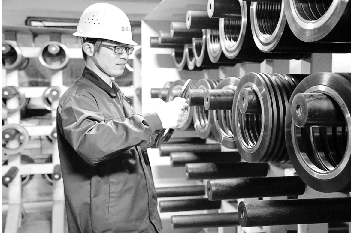
日前,金成铜业分公司积极开展工器具5S行迹管理,将模具、刀具、维修工具等集中分类规范放置,减少占用空间,并做好标识,形成可视化管理,使各类工器具一目了然,方便查找,极大地提高工作效率。图为员工正在分类摆放板带材剪切专用刀具。
