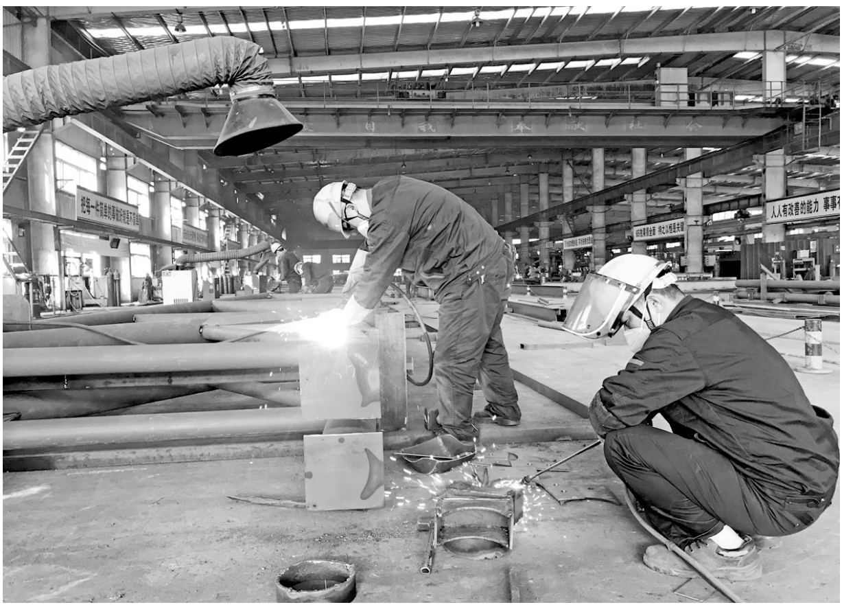
2月22日,铜冠建安钢构公司职工正在焊接钢构件和下料作业。这是他们紧锣密鼓加工铜陵黄麓科技有限公司5栋厂房构件、浙江海亮2号厂房、金冠铜业分公司制氧项目及铜冠池州公司多金属项目构件,为项目现场施工创造条件。目前,该公司广大职工正以时不我待之势开好头,迈好步,大干在手工程项目,创造优异成绩。 王红平 汪锡铜 摄
