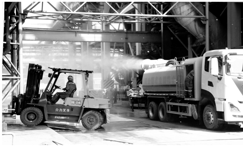
金隆铜业公司环保水炮车正在施工区域洒水雾(如图)。该公司在企业生产过程中,注重环保为先,任何工程施工,必须先进行环保评估,同时对施工现场的扬尘进行严格控制,杜绝因施工带来的环保风险,确保生产区域蓝天碧水清空气。章庆 丁红琴 摄
