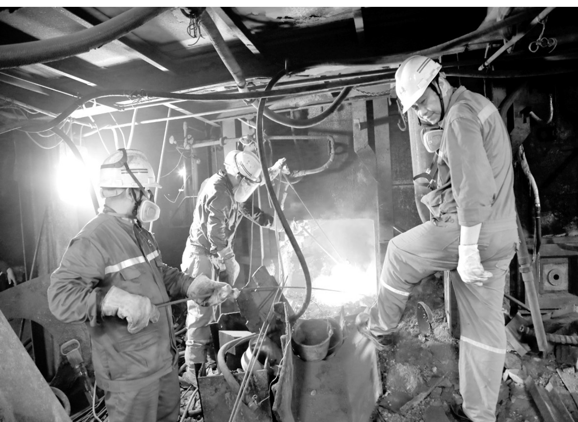
金隆铜业公司在进行均衡生产的同时,对生产操作方式不断进行改良和优化,使每道工序的生产工序配合更加紧密,衔接有序,有力推进了公司整体生产能力的提高,去年该公司全面超额完成生产任务,实现了高质量发展的目标。图为该公司职工正在进行竖炉放铜口的改良制作和优化工作。
