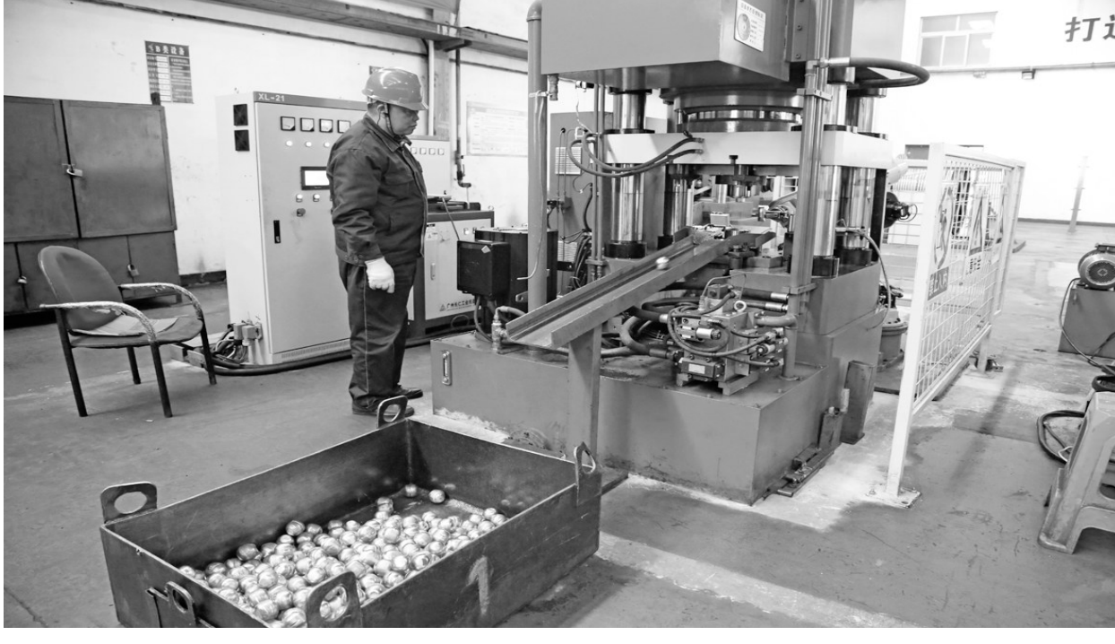
铜陵有色股份线材公司员工日前正在生产超大规格阳极磷铜球(如图)。过去的一年,铜陵有色股份线材公司通过新建高速球机生产线,实现了超大规格阳极磷铜球规模化生产,积极抢占下游PCB行业高端客户,使产品结构得以优化,也增加了经济效益。王红平李庆摄
