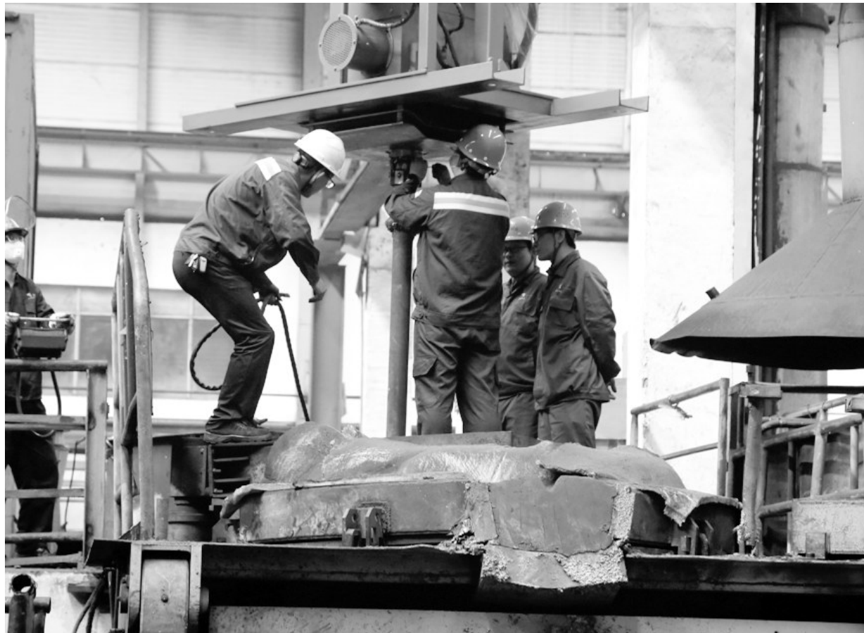
金冠铜业分公司员工日前正在对熔铸设备改造。该公司通过对熔铸系统进行环保改造,加大了熔铸生产时烟气、粉尘回收,既改善了现场作业环境,又做到环保生产。
