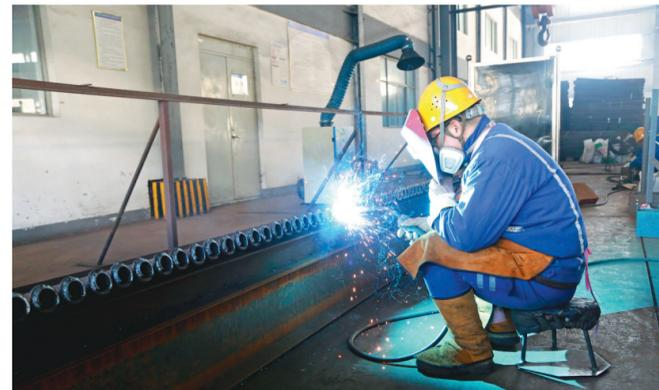
日前,铜冠矿建公司机械修造分公司员工正在制作锚杆中焊接作业。铜冠矿建公司机械修造分公司新的一年里,在扩大设备修理范围和提高修理能力的同时,将努力扩大锚杆制作,稳定锚杆产量和质量,进一步拓展市场范围,提高效益。 王红平 曾红林 摄
