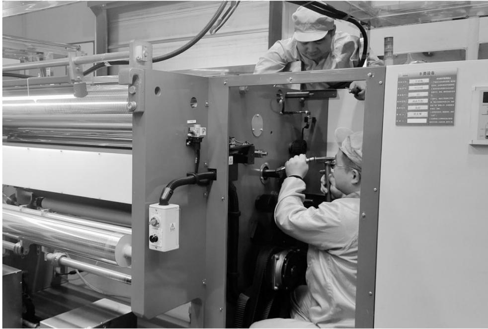
日前,铜冠铜箔公司铜箔一二工场充分利用溶铜更换E列循环槽的窗口期,组织人员对生箔机、表面处理机、分切机等设备进行细心检修维护,确保各类生产设备运行安全可靠,为生产提供更优质的设备保障。图为设备维护人员正在对分切机驱动轴轴承等进行检修维护。吴云霞 孙友菊 摄
