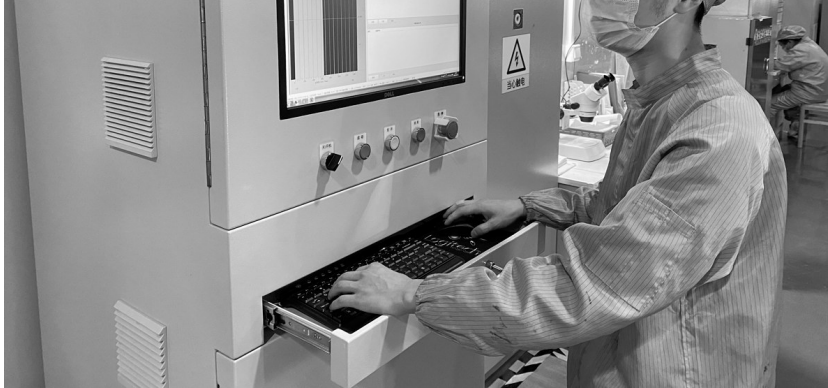
今年以来,铜陵铜箔公司不断加强产品品质把控,努力提升高端产品比例。图为成品车间员工目前正在利用新引进的CCD平面材料缺陷检测系统,对铜箔产品外观进行高精度检测。据悉,该系统采用人工智能图像算法,对采集到的膜表面信息进行处理分析,若出现异常膜面情况可以实时提供报警警示。 刘洋 摄
