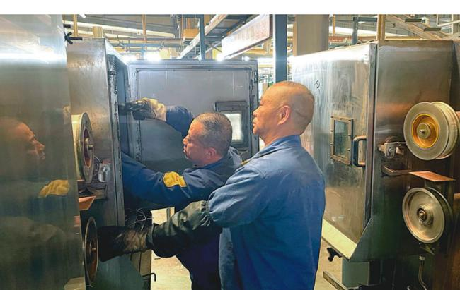
今年以来,铜冠电工公司制定年度设备维修保养计划,采用生产现场目视化管理、定期设备点检、定期设备润滑等方法,进行设备维护保养,降低故障停机时间,保证生产需要。图为近日该公司维修人员正在对漆包设备进行维保点检。
