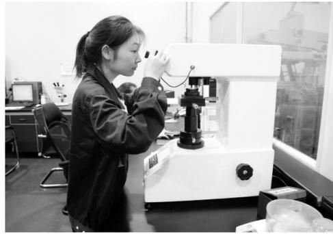
铜陵格里赛公司员工正在检测异型铜带样本硬度。铜陵格里赛公司在狠抓产品生产过程质量控制的同时,严把产品检测检验关,较好地保障了产品质量稳定,今年以来异型铜带综合成品率达到了80%。
