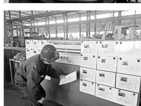
铜冠机械公司装配车间员工日前在组装中对照悬挂的图片(如图)。为规范产品装配工序,打造高质量产品,该公司采取在装配现场悬挂产品作业指导书和装配工序卡,以便员工在产品装配时对照进行正确安装。
