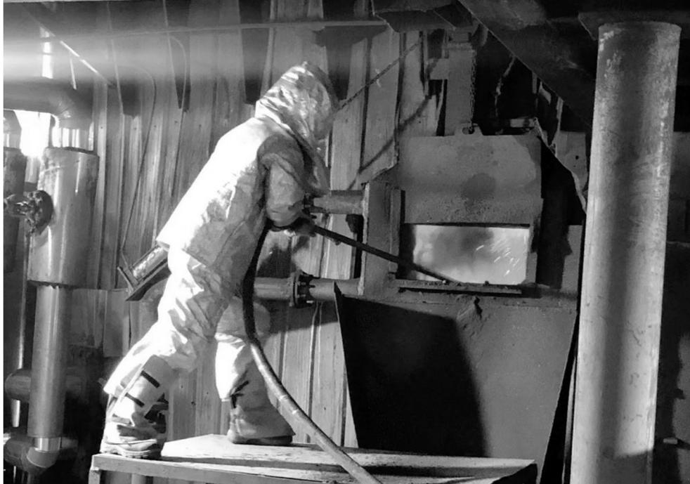
铜冠池州公司锌分厂通过开展配料攻关,稳定入炉料成分,强化设备管理,降低设备故障率,加强探炉作业,确保了焙烧炉稳定运行,截至11月底,焙烧炉开车率达到98.85%,创历史新高。图为员工在炉前进行探炉作业。 何夏雨 摄
