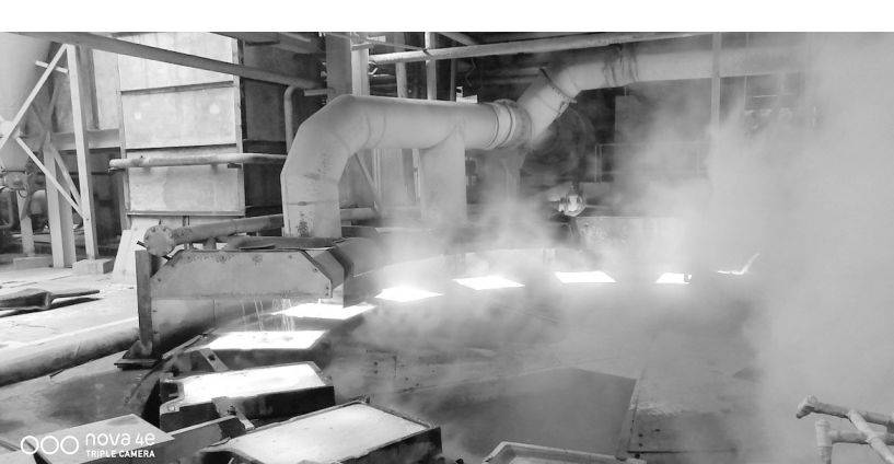
精炼阳极板浇铸系统。
