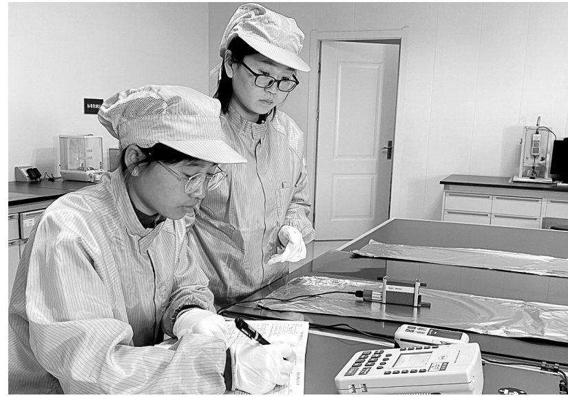
下半年以来,铜冠铜箔公司智能实验室信息管理系统投入使用,各车间能在第一时间查看产品的检测数据,及时调整生产参数,从而不断提升产品质量。图为铜冠物理检测室员工正在进行铜箔的粗糙度检测。
