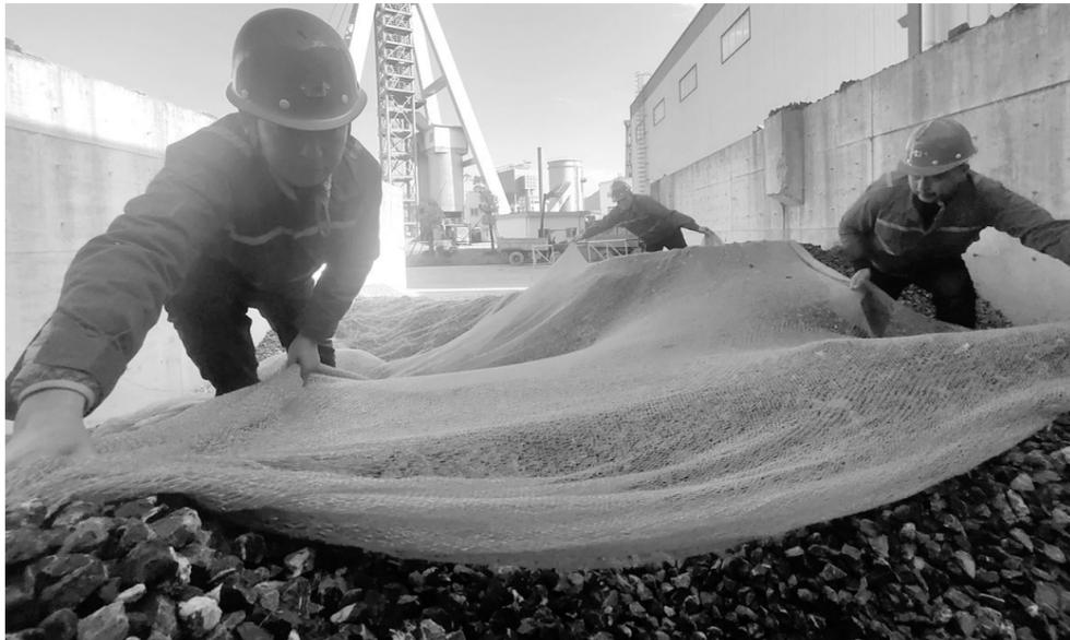
11月23日，铜山铜矿分公司员工在对露天堆场石料覆盖防尘网(如图)。据了解，入冬以来，天气干燥少雨，该公司多举措强化扬尘综合治理，每天安排专人对矿区主干道进行清扫，主要产尘点雾炮机洒水降尘，露天砂石料堆场覆盖防尘网，全力抑制扬尘污染，让蓝天常驻矿山。
