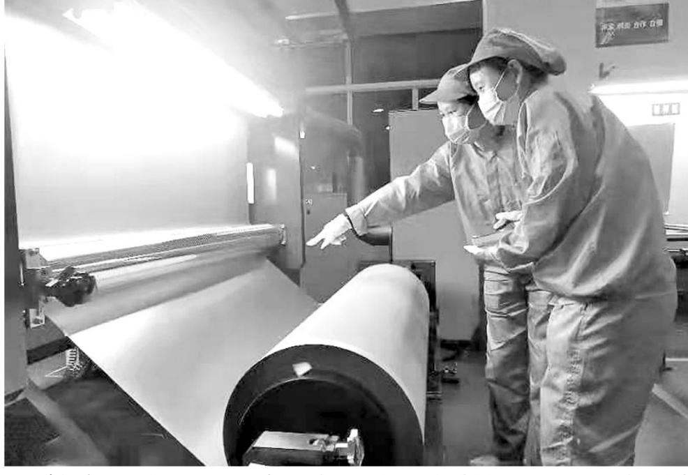
四季度以来,铜冠铜箔公司池州三四工场在加强设备的点检、维护和开展全员技能培训的同时,积极发挥专业技术骨干“传帮带”作用,保障各主产设备始终保持满负荷生产状态。图为该工场特种箱分切工段技术骨干现场教学新员工在镜头前检查铜箔外观。 **方知炜 崔素玲 摄**
