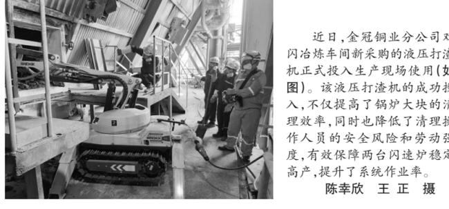
近日,金冠铜业分公司双闪冶炼车间新采购的液压打渣机正式投入生产现场使用(如图)。该液压打渣机的成功投入,不仅提高了锅炉大块的清理效率,同时也降低了清理操作人员的安全风险和劳动强度,有效保障两台闪速炉稳定高产,提升了系统作业率。 **陈幸欣 王 正 摄**
