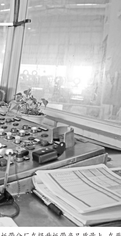
金威铜业分公司板带分厂粗轧机组员工日前正在生产作业。金威铜业分公司板带分厂在提升板带产品质量上，在严格执行工艺流程和操作规程标准化的同时，积极改进操作方法。其中，今年通过对粗轧机优化张力设置，采用衬纸等措施，促进了厚带表面质量明显改善。王红平 黄军平 摄
