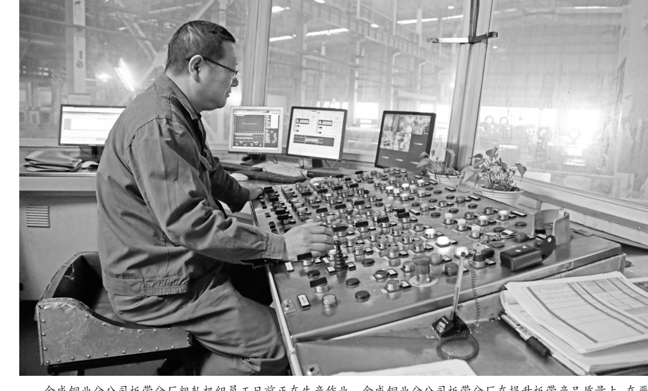
金威铜业分公司板带分厂粗轧机组员工日前正在生产作业。金威铜业分公司板带分厂在提升板带产品质量上，在严格执行工艺流程和操作规程标准化的同时，积极改进操作方法。其中，今年通过对粗轧机优化张力设置，采用衬纸等措施，促进了厚带表面质量明显改善。王红平 黄军平 摄
