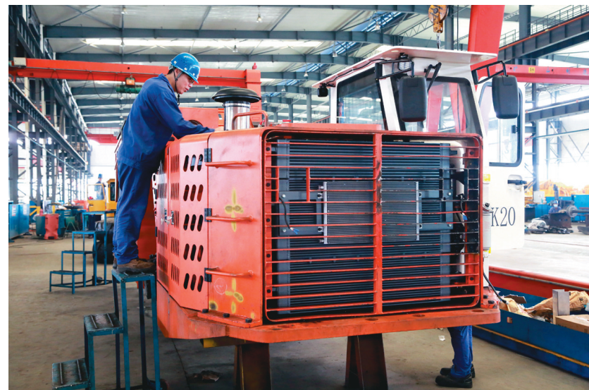
铜冠机械公司设备装配分厂员工日前正在装配20吨井下卡车。铜冠机械公司在井下无轨设备生产上根据市场变化,积极按客户不同的要求,开展个性化产品生产。近期,该公司承接了一家客户3台20吨井下卡车升级改装订单,并组织技术力量,对照客户改进要求对卡车进行技术升级改造。
