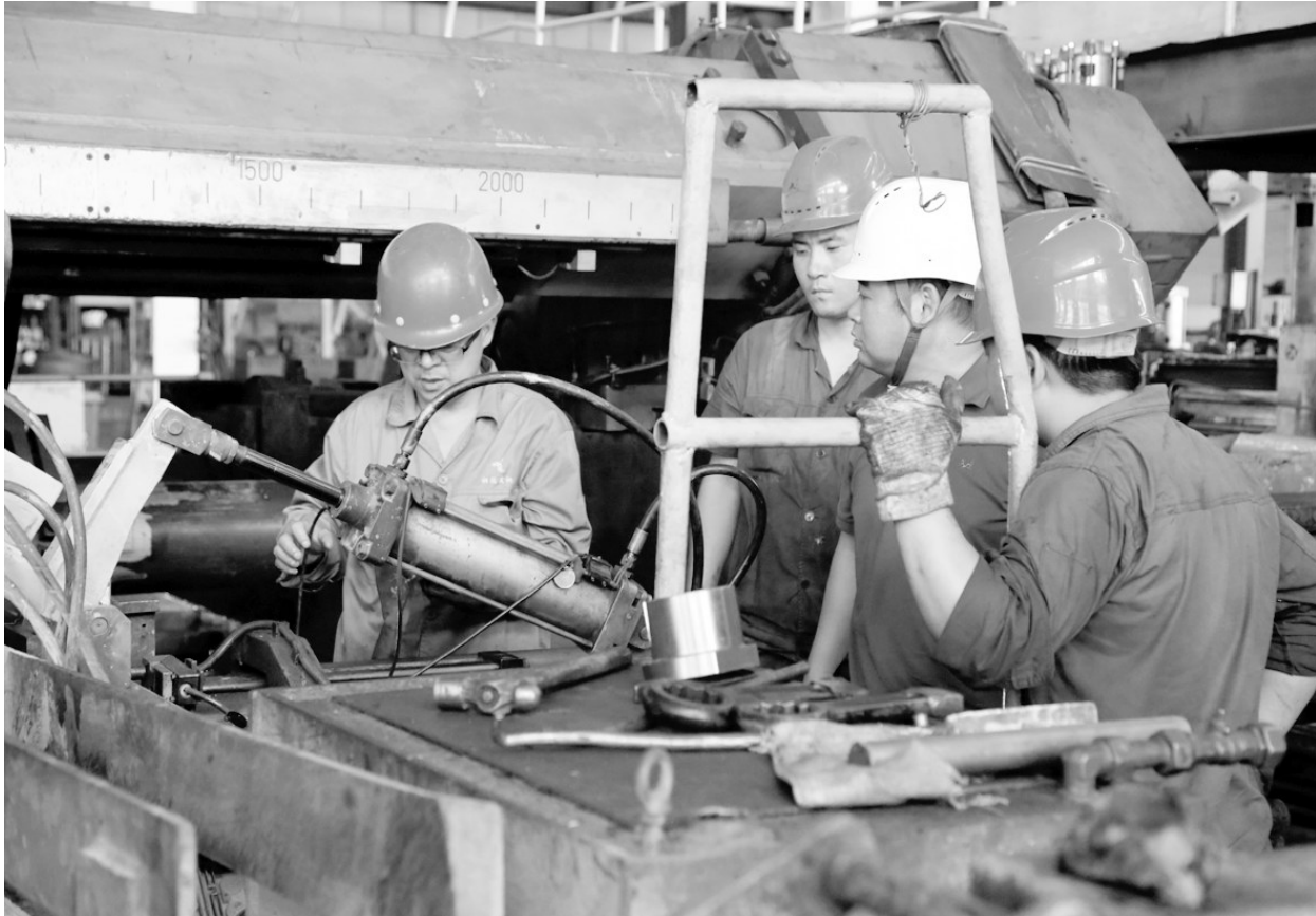
铜冠黄铜公司员工正在检查挤压机(如图)。该公司在挤压机系统停机恢复生产前,为保障挤压机系统顺利重新启动,生产恢复正常运转,积极组织技术人员认真对挤压机系统进行了一次全面检查,将可能存在的故障及时排除。王红平 汪勇 摄
