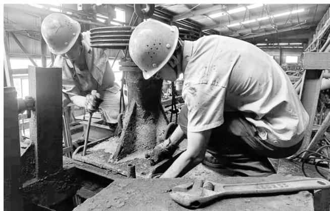
日前,天马山矿业公司选矿车间利用停车间隙,组织开展设备维修维护工作,确保设备正常运行。图为该车间职工更换金精矿浆搅拌桶立轴。 吴燕 摄
