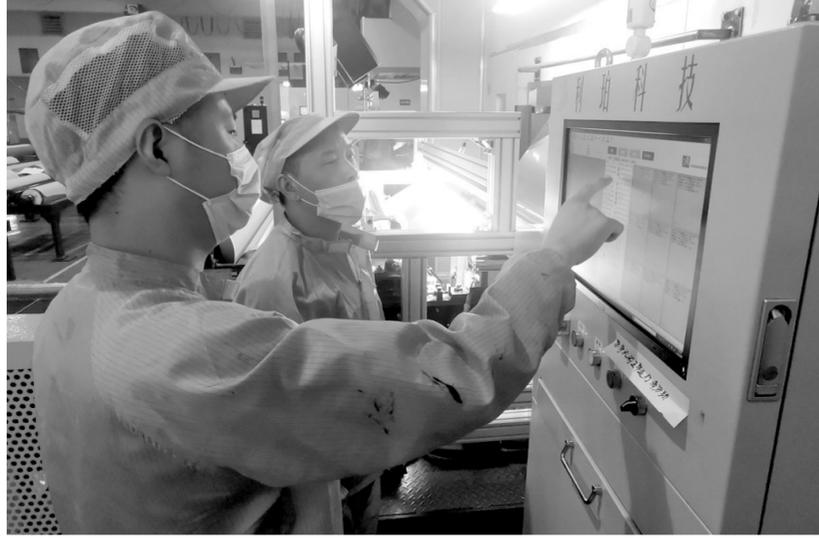
为降低铜箔表面的残铜发生率,今年以来,铜冠铜箔公司池州铜箔第一党支部将“消除表面处理残铜的工艺研究”作为党建项目重点攻关,通过半年多时间的改造和调试,残铜发生率由实施前的10.3%降低至0.3%。图为项目组成员对加装的在线监测设备进行调试。 方知炜 摄
