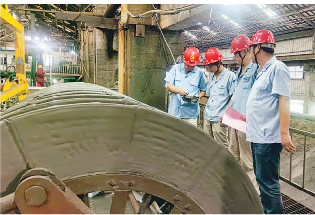
日前,天马山矿业公司选矿车间党支部认真推进“降低硫精砂水分,延长陶瓷过滤机陶瓷板使用寿命”党建项目攻关,攻关项目组成员加强过程指导,现场分析推进,目前已实现了减少陶瓷过滤板堵塞现象,延长了使用寿命。图为党支部攻关组成员在陶瓷过滤机前查看硫精砂水分。 吴燕 摄
