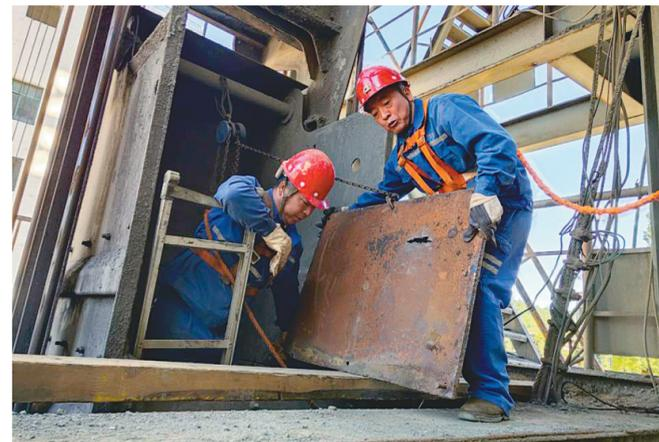
日前，铜山铜矿分公司运转车间维修人员在提升斗衬板进行更换。进入下半年，这个公司以“每日一查”活动为抓手，在加强现场5S精益管理的同时，加大现场设备的运、维基础，及时排除设备故障，提高设备完好率。张霞 摄
