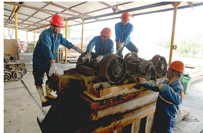
安庆铜矿在抓好安全的同时,采取多条措施确保一条龙生产的顺畅,力争实现全年安全、生产双丰收。图为该矿机工区的维修工在维修井下矿车,确保安全生产。 杨勤华 摄
