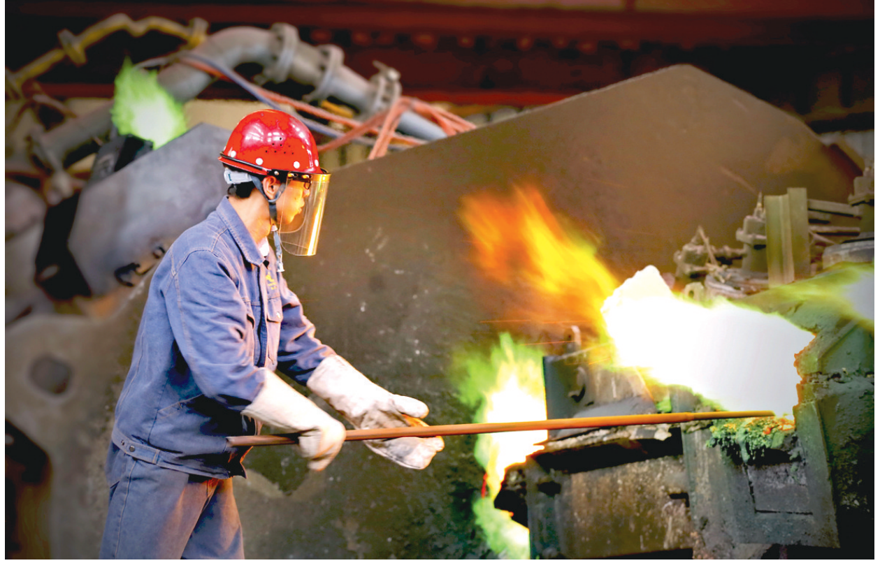
今年以来，铜冠电工铜材公司强化铜杆生产管理，严格监控产品系统温度、熔化速率、浇注速度等重要生产环节，保证浇注铜液的温度稳定，持续提升铜杆A杆的产品质量。图为该公司生产骨干正在及时进行炉口铜液加料调节作业。 华伟 摄
