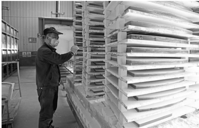
铜冠机械公司陶瓷板分厂员工正在清理刚出炉的陶瓷板。该公司今年以来加大陶瓷过滤器重要备件陶瓷板的生力度,在满足自身装配需要的同时,全力加大陶瓷板的销售,取得积极成效。
