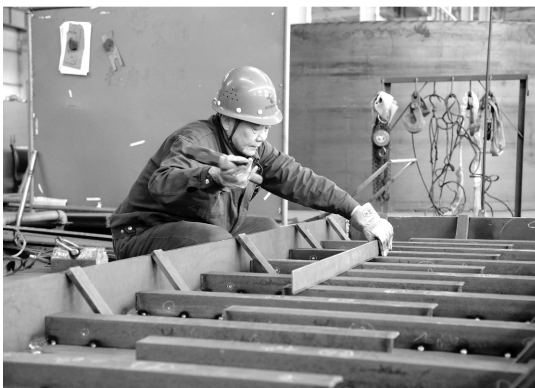
铜冠机械公司备件制造分厂员工正在加工阳极炉水套(如图)。该公司备件制造分厂从3月初开始承担了出口塞尔维亚的阳极炉水套加工制造任务,并通过合理安排人员,优化制作工艺,保证了加工进度,有望在5月底按期完工。王红平 廖肇迪 摄
